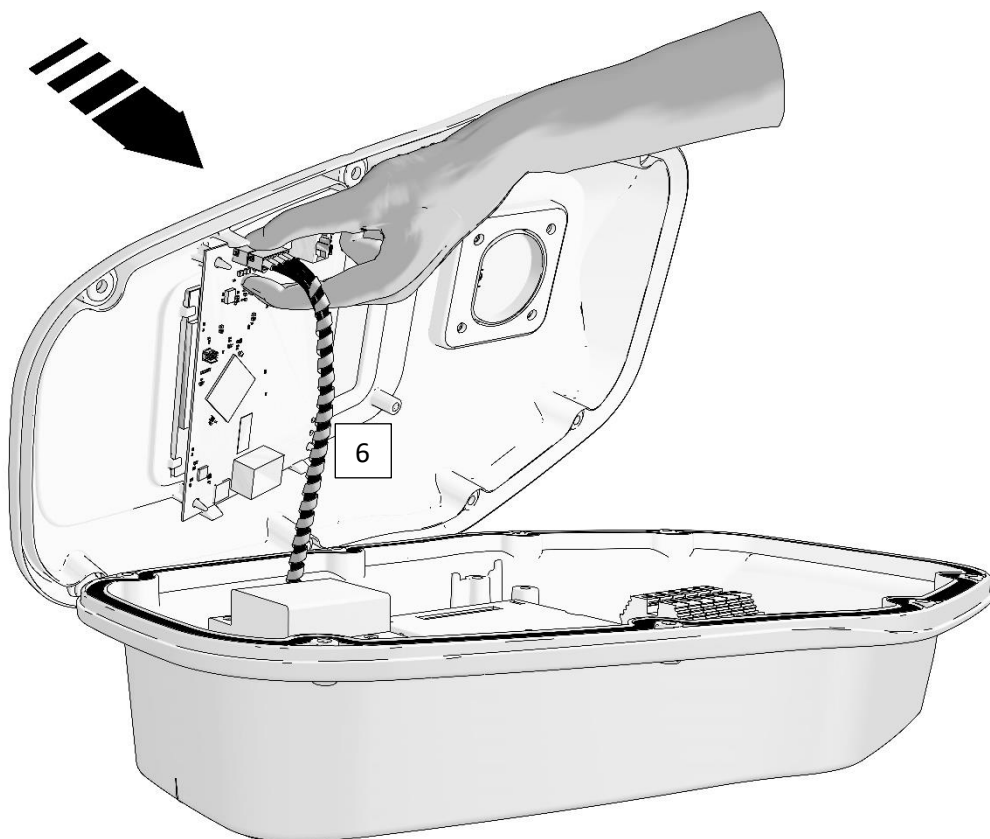
Obrázek 6 Odpojení spojovacího kabelu
